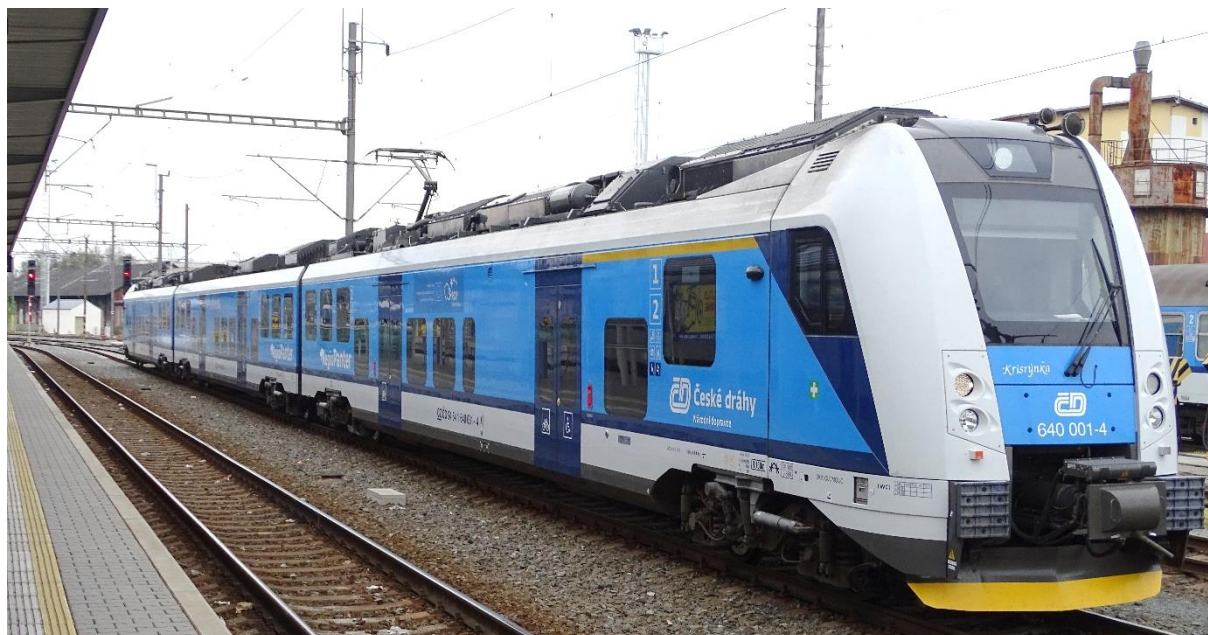
Obrázek 2: Elektrická jednotka řady 640 platformy RegioPanter.
