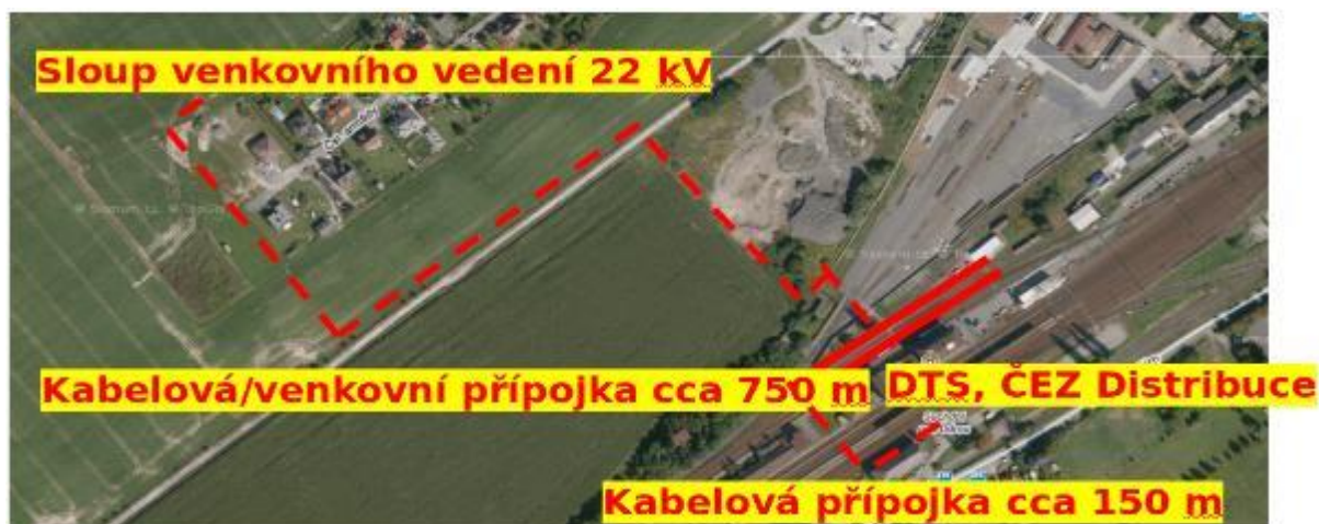
Obr. 5 Dva alternativní přívody na nástupiště pro vlaky ve směru Fulnek a Budišov nad Budišovkou
