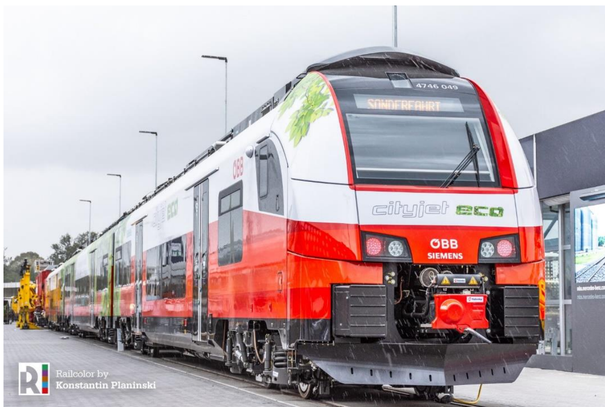
Obrázek 3: Dvouzdrojová jednotka trolej/akumulátor Siemens Desiro ML.
