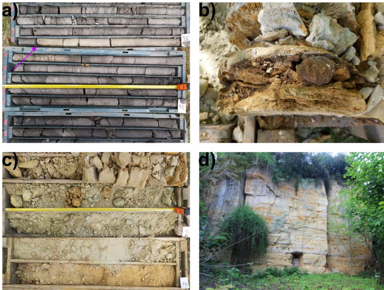
Obr. 9 a) Tmavošedé jílovité břidlice letenského souvrství (ordovik), které směrem do nadloží přecházejí do vyběleného horizontu kaolinicky zvětralého ordoviku (metráž 34,1 – 35,4 m – fialová šipka). Na tyto zvětraliny nasedají tmavošedé jílovce peruckých vrstev (cenoman) s kořenovými půdami a slojkami uhlí (metráž 28,65 – 34,1 m). b) Rezavé limonitické krusty a železité pískovce o mocnosti 0,05–0,5 m zjištěné na bázi korycanských vrstev. c) V nejvyšších polohách korycanských vrstev jsou pískovce silně glaukonitické, zelenavé barvy. Vrt HJ-16 u ÚVN. d) Výchozy a bývalé lomy v tzv. střešovických stěnách (PP Střešovické skály) mezi vrty PJ-07 a HJ-15 (foto M. Aue 24. a 27. dubna 2020, S. Čech 4. května 2020).
