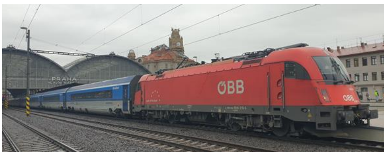
Obrázek č. 1: Na moderní infrastrukturu patří moderní vozidla. Moderní třísystémové lokomotivy ÖBB řady 1216 zajižďejí s netrakčními jednotkami railjet i do Prahy Zdroj: autor
