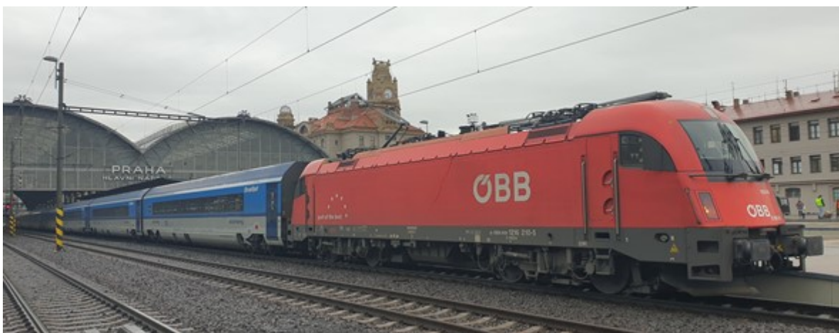
Obrázek č. 1: Na moderní infrastrukturu patří moderní vozidla. Moderní třísystemové lokomotivy ÖBB řady 1216 zajíždějí s netrakovými jednotkami railjet i do Prahy. Zdroj: autor
