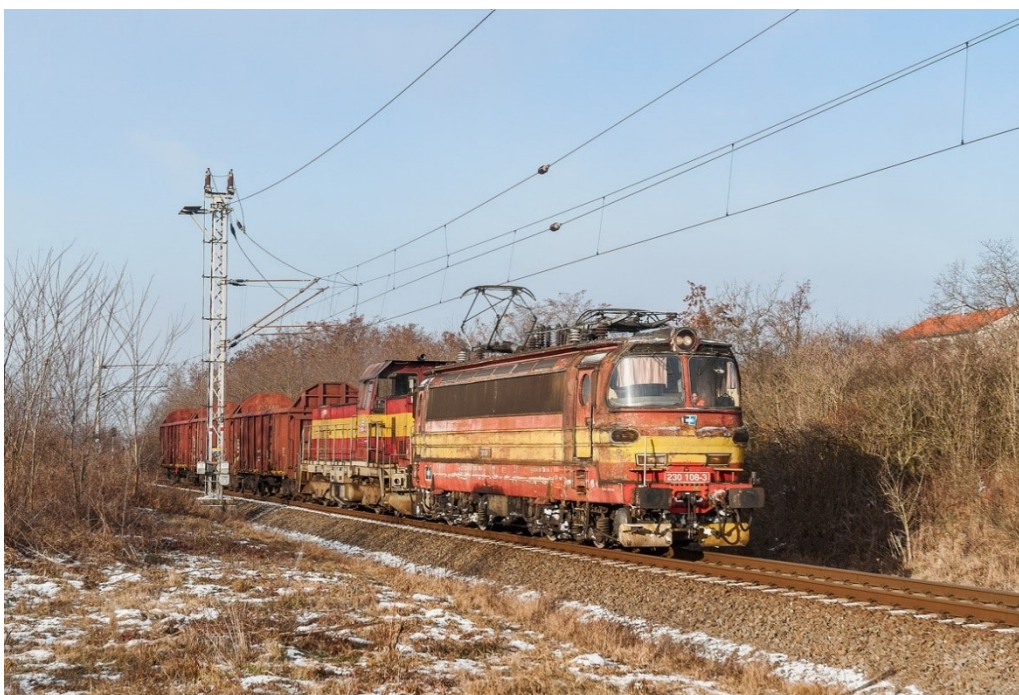
Obr. 1 Elektrická lokomotiva řady 230 na manipulačním vlaku spolu s dieselelektrickou (řada 731). Zdroj: autor
