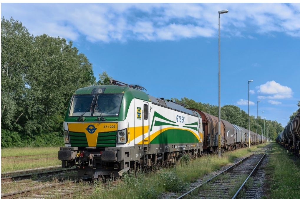
Obr. 2 Lokomotiva Siemens Vectron AC, vybavená pomocným spalovacím motorem, s vlakem na vlečce mimo trakční vedení. Zdroj: autor
