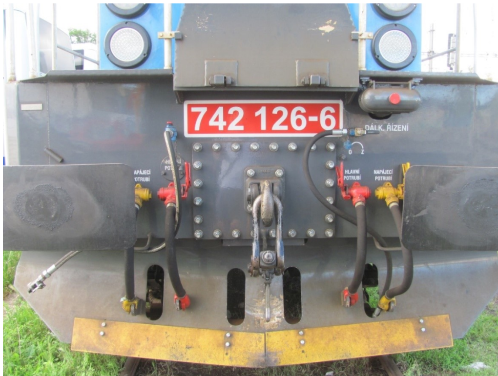
Obr. 3: Současný stav přípravy na výměnu evropského spřáhla na lokomotivě 742.126. Benešov u Prahy, 7. 7. 2020. Foto autor.
