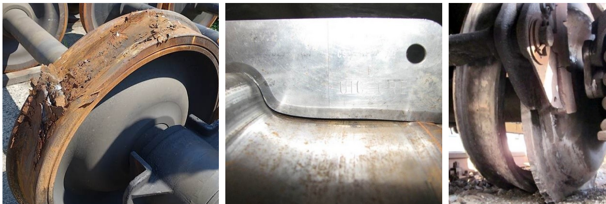
Obr. 4 Charakteristické projevy působení nekovových („K“ a „LL“) brzdových špalíků na kola: nápeče (vlevo) a projetý žlábek (vpravo); převzato z prezentace [11].
