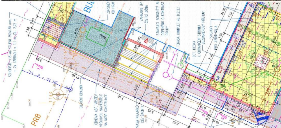
Obrázek 2 - Žst. Kopřivnice nemá jediný bezbariérový přístup z okolí. Ani rozsáhlá rekonstrukce tento problém neřeší, neboť stavba končí varovnými pásy pod a nad schodištěm na hranici drážního pozemku.
