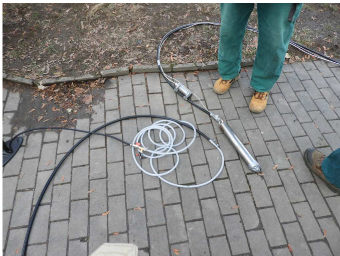
snímač do vrtu se závažím, hadice na natlakování
