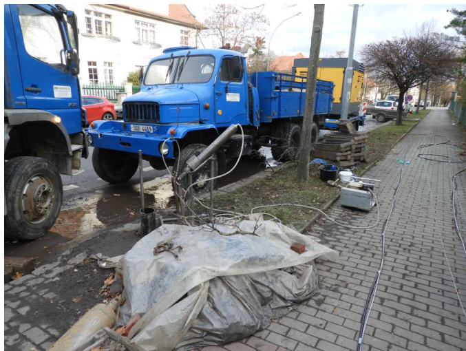
dynamická penetrace – soutyčů vloženo do vrtu
