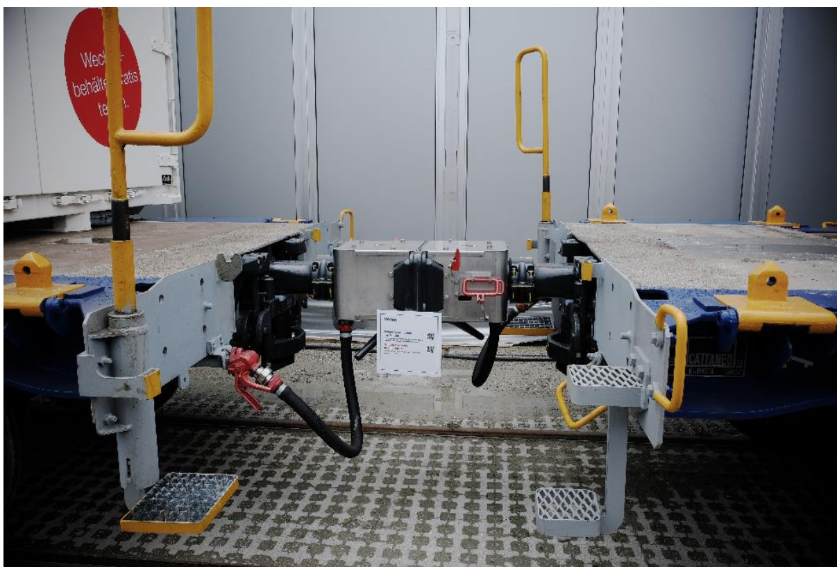
Obr. 2: Automatické spřáhlo pro nákladní vozy
