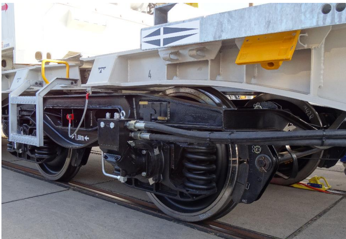
Obr. 3: Hydraulický nápravový generátor
